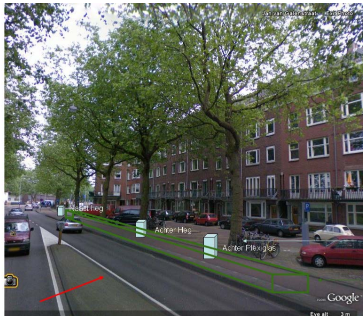
Figuur 21 De meetpunten voor onderzoek aan de haag met en zonder plexiglas in de Jan van Galenstraat op locatie 3a.
